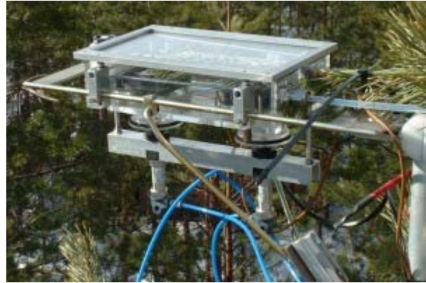
7. Hier versuchen Forscher mit einer Zweig-Küvette die Aufnahmerate der Bäume für Kohlendioxid zu ermitteln (Messung in Hyytiälä / Finnland). Dies ist jedoch weit unsicherer als den relativ stabilen CO 2 Wert in Hintergrund-Luft zu bestimmen. Quelle: Universität Helsinki
