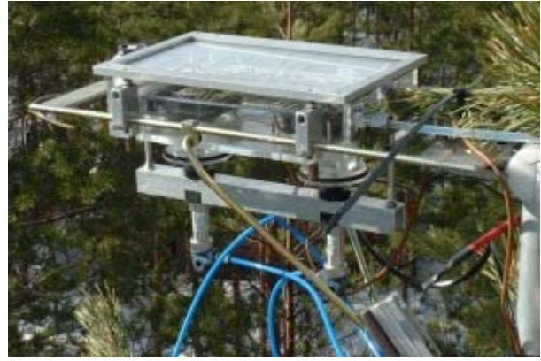
7. Misurare la velocità di assorbimento dell'anidride carbonica da parte degli alberi (qui vediamo un esempio di campionamento effettuato a Hyytiälä / Finlandia) è molto più complesso che misurare le concentrazioni in aria di CO 2 che sono relativamente stabili. Clicca sulla foto per ingrandire l'immagine (160K)! Fonte: Università di Helsinki
