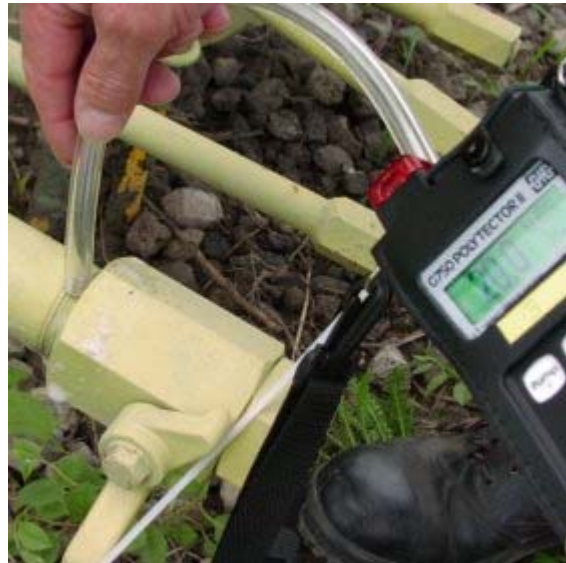
10. Überprüfung mit dem Methandetektor
