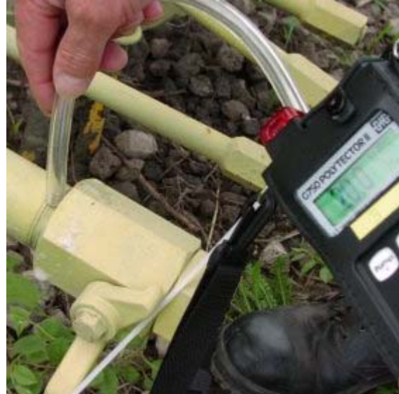
10. Controllo con un rivelatore di metano
