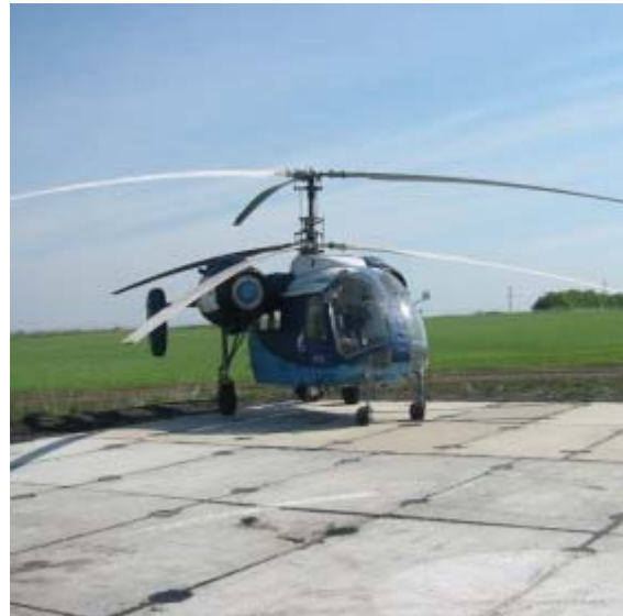
12. Un piccolo elicottero dotato di rivelatore laser per il controllo del gasdotto. © LA
