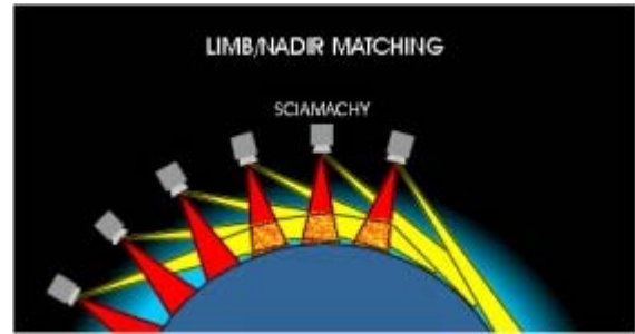
9. Nadir-Limb-Matching: Hintereinander durchgeführte Messung desselben Atmosphärenausschnittes in beiden Modi. © IUP Bremen
