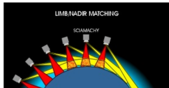
9. Nadir-Limb-Matching: misure consequenziali della stessa parte dell'atmosfera in entrambe le modalità © IUP Brema
