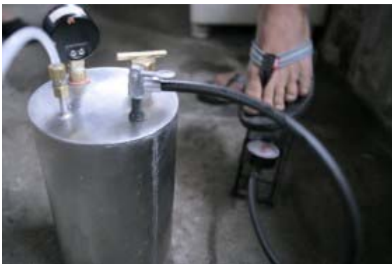
11. La pressione viene generata tramite una semplice pompa manuale © BSH
